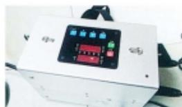
电磁熔焊机
